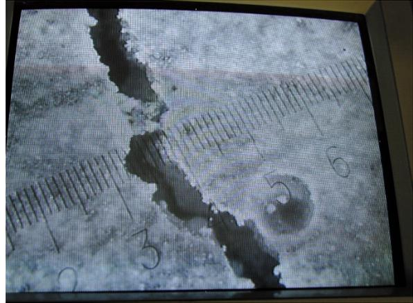
Figura 4- Endoscopia: a sinistra impiego della sonda ottica; a destra osservazione dei difetti non visibili ad occhio nudo
